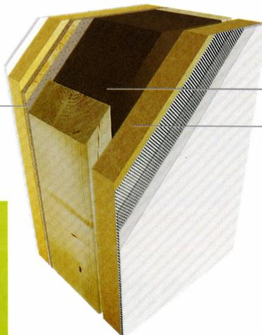
Holzfaserdämmplatte 200 mm
